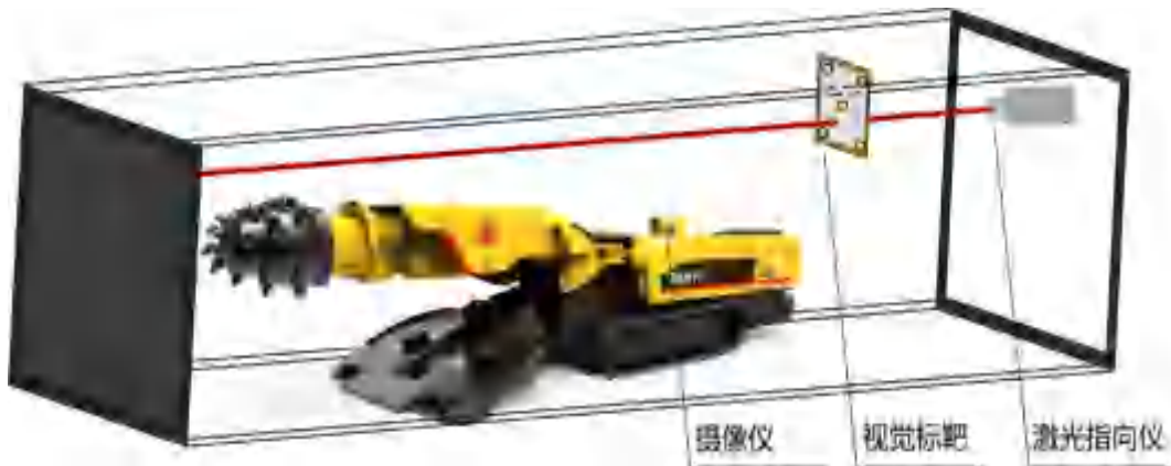
图 8 掘进机位姿偏向位移的测量原理图
