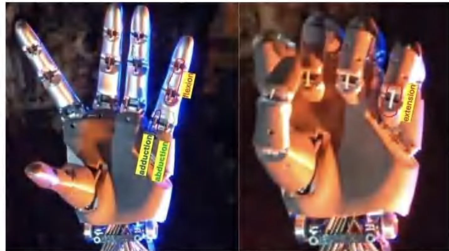
图表 52: Optimus gen3 灵巧手保留末端腱绳的传动形式
