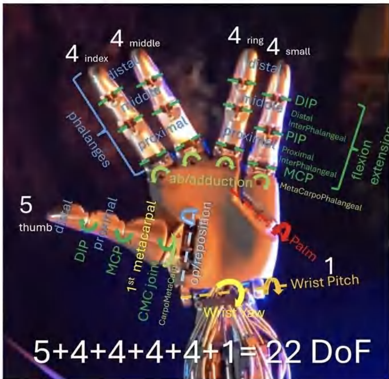
图表 50：Optimus gen3 灵巧手自由度提升至 22 个
