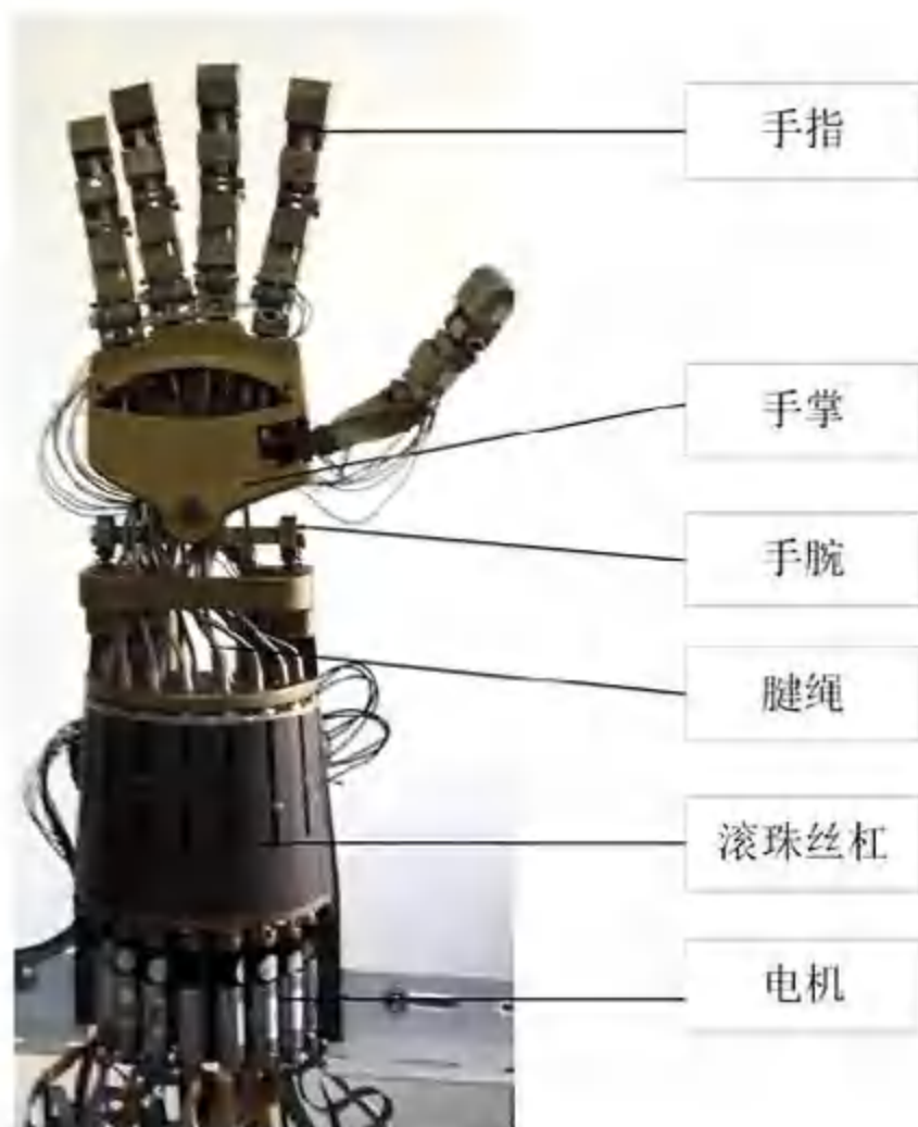
图表 32：腱绳传动灵巧手整体机构
