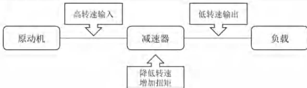
图表 21：减速器工作原理
